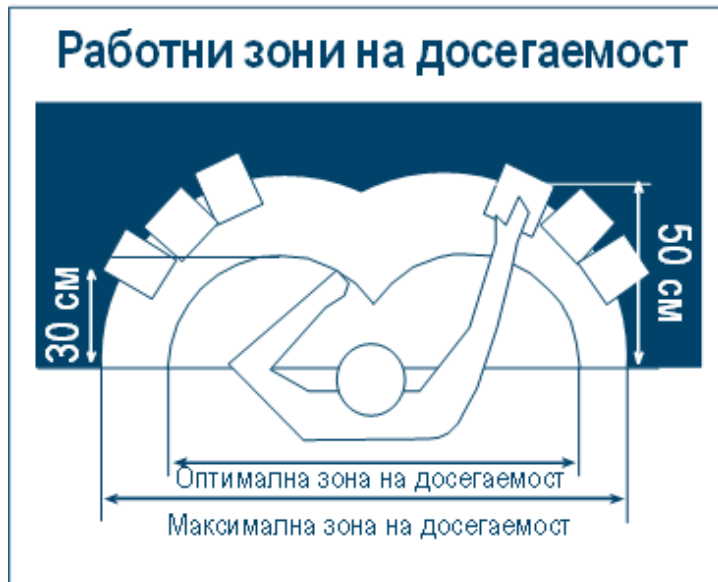
ФИГУРА 2 РАБОТНИ ЗОНИ НА ДОСЕГАЕМОСТ – ОПТИМАЛНА И МАКСИМАЛНА
