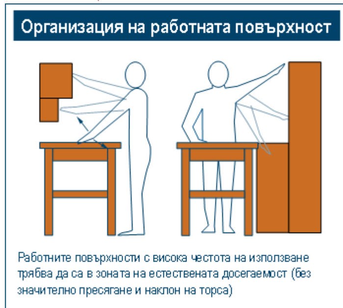
ФИГУРА 1 ОРГАНИЗАЦИЯ НА РАБОТНАТА ПОВЪРХНОСТ В СЪОТВЕТСТВИЕ С ЕСТЕСТВЕНАТА ДОСЕГАЕМОСТ НА РЪЦЕТЕ
