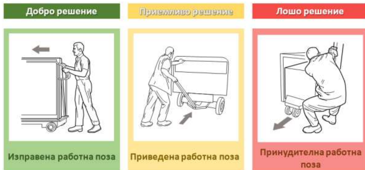
ФИГУРА 10 ПРИМЕРИ ЗА ДОБРИ И ЛОШИ РЕШЕНИЯ ПРИ ПРИЛАГАНЕ НА СИЛА, СВЪРЗАНА С ОБРАБОТКАТА НА ГОЛЕМИ И ТЕЖКИ ТОВАРИ С КОЛИЧКИ
